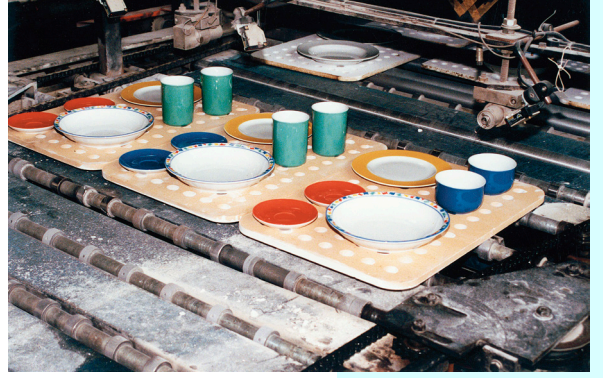
rololu fırında sofra takımlarının pişirilmesi
